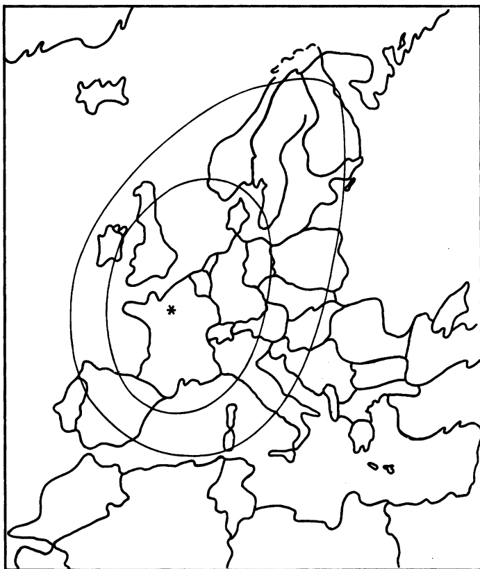
Рис. 4.25. Зона связи ИСЗ Unisat (Западная Европа). Уровень на внутреннем контуре 3 дБ, наружном 6 дБ относительно максимума
