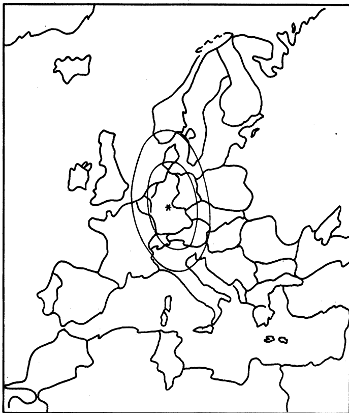
Рис. 4.26. Зона связи ИС3 DFS. Уровень на внутреннем контуре 3 дБ, наружном 6 дБ относительно максимума
