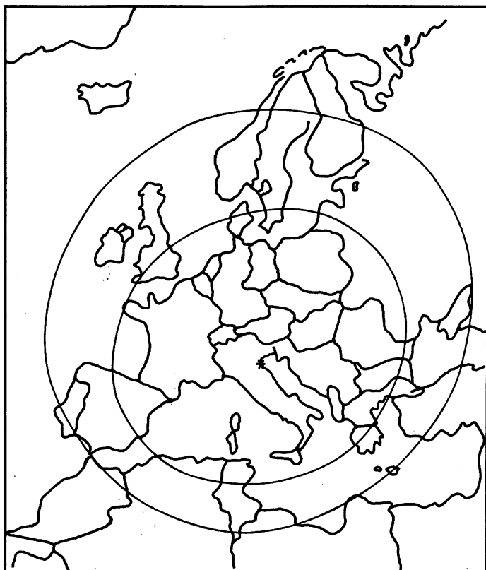
Рис. 4.20. Зоны обслуживания спутниками серии ECS-F2 (Eutelsat/CMC). Уровень на внутреннем контуре 2 дБ, наружном 4 дБ относительно максимума
