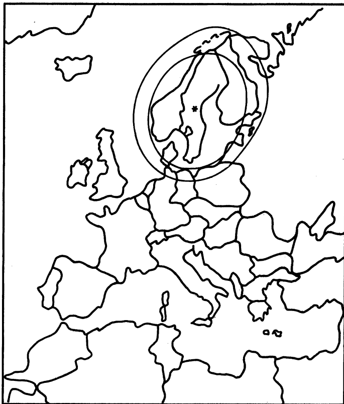
Рис. 4.30. Зона связи ИСЗ Tele-X. Уровень на внутреннем контуре 3 дБ, наружном 5 дБ относительно максимума
